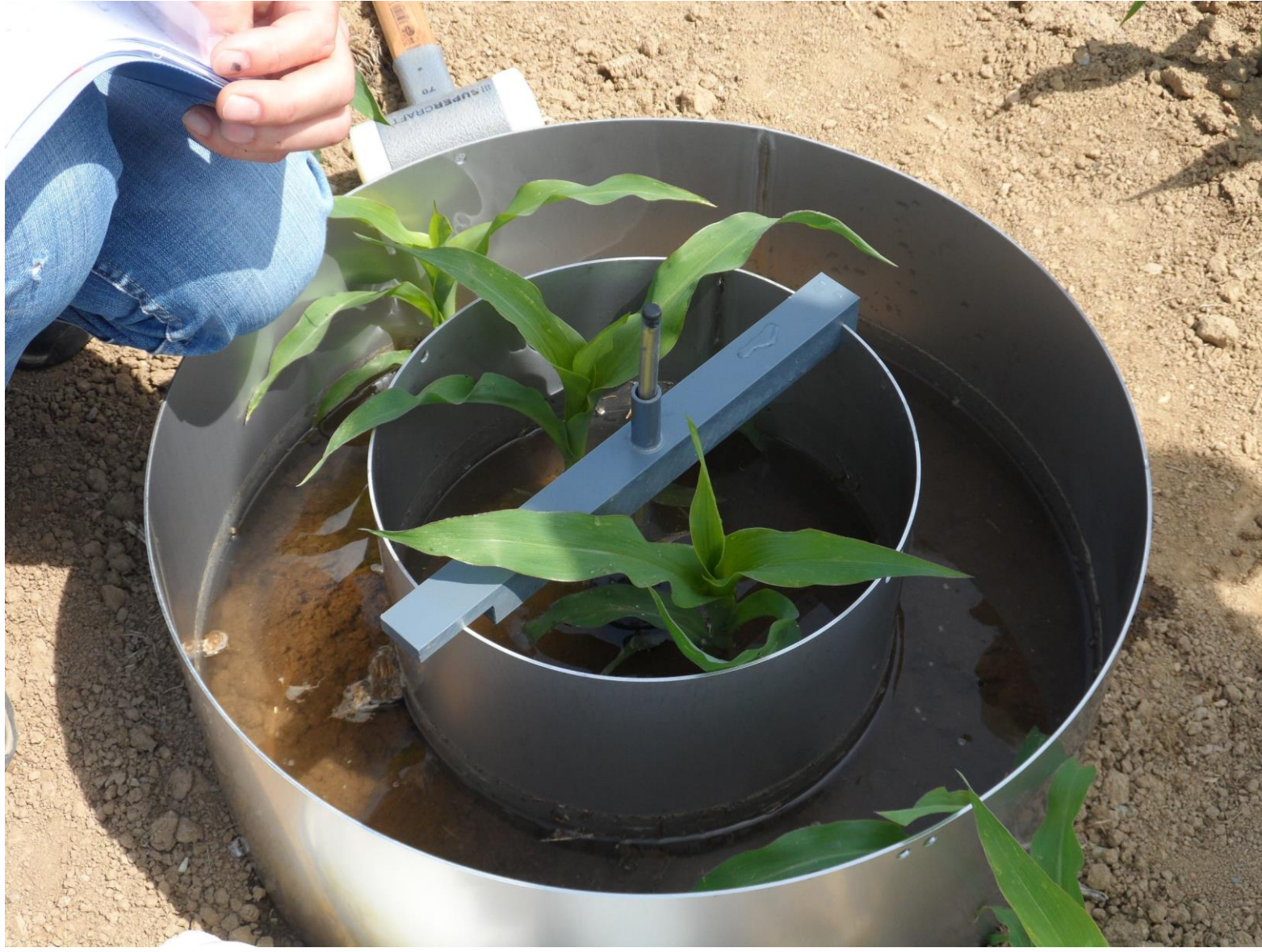
Mit dem Doppelringinfiltrimeter wird der K_f -Wert (Versickerungsfähigkeit) ermittelt.
